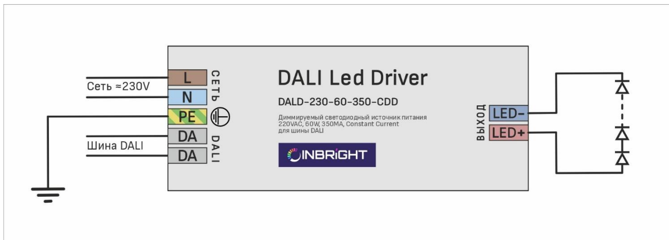
Рисунок 3. Схема подключение DALI Led Driver
